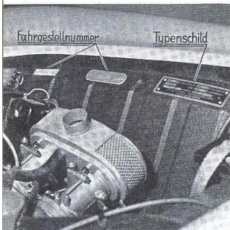
La plaque signalétique et le numéro de châssis sont sous le capot, sur le caisson de roue droit (voir image).
