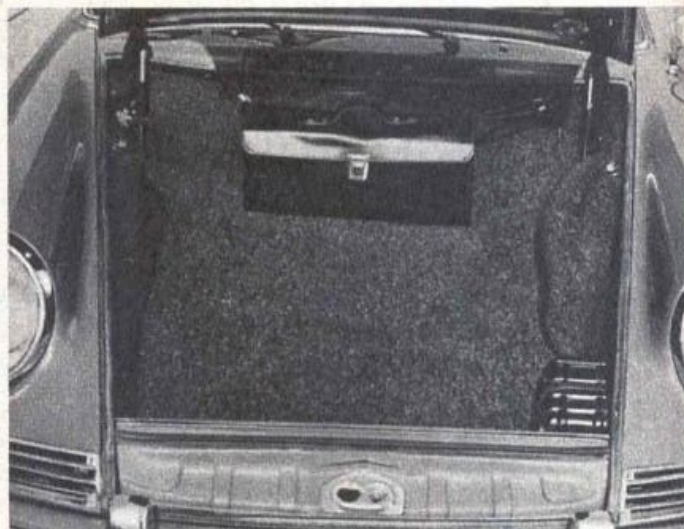
Wunschtraum vieler Käfer-Besitzer ist ein solcher Kofferraum, der beim Porsche nur dadurch geschaffen werden konnte, daß die Drehstäbe längs eingesetzt sind.
