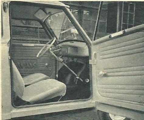
men der typischen Goggomobil-Konstruktion auch gar nicht möglich oder astronomisch teuer. Daß die kleinen Typen weitergebaut werden sollen, zeigt die Investition von 700 000 DM in die Verlegung der Türscharniere nach vorn (Türen „vorn angeschlagen“) nach der geänderten Vorschrift für neuproduzierte Wagen.
