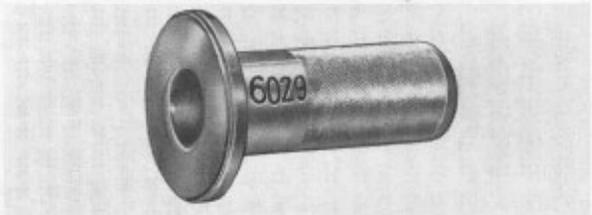
Aus- und Einziehvorrichtung für das Traggelenk.
