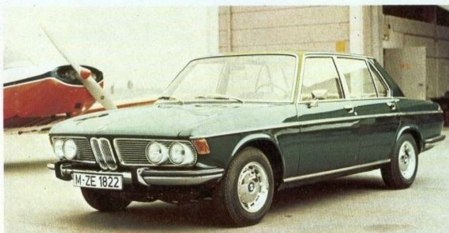
Ci-dessus : la BMW 2500/2800 ; c'est une berline de luxe dont on voit le moteur à droite. Il s'agit d'un 6 cylindres en ligne à arbre à cames en tête et soupapes en V de 150 ch pour la 2500 et de 170 ch pour la 2800. (Cl. Quattroruote.)
