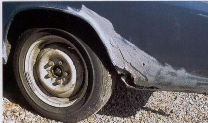
Eine schwere Prüfung, nur für geübte Blech-Artisten zu empfehlen: Im Steinschlagbereich der Hinterräder hat der hartnäckige Gammel großflächig Schaden angerichtet
