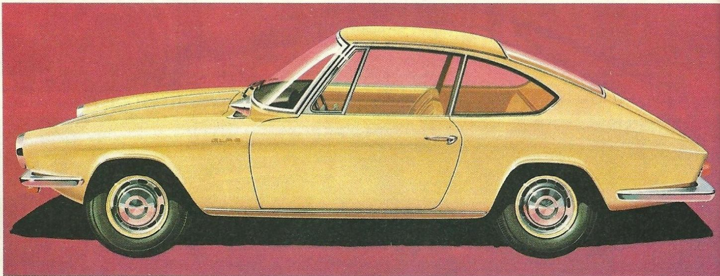
Der Glas 1300 GT war mit seinem 75-PS-ohc-Motor 170 km/h schnell, was er nicht zuletzt seinem günstigen Leistungsgewicht von 10,7 kg/PS verdankte.
