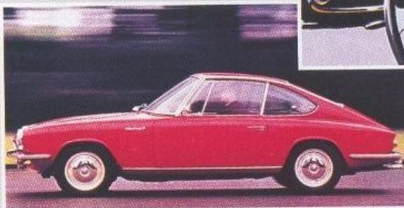
*La prise d'air sur le capot permet de dater ce document du printemps 1965, car les premières 1300 GT (en photo page 31) n'avaient que deux fines nervures.*
